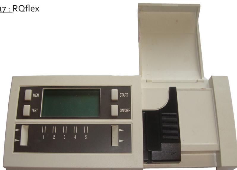
La méthode consiste à une réduction des nitrates en nitrites par un réducteur qui en présence d'un tampon acide forment avec une amine aromatique un sel de diazonium. Celui-ci réagit avec la N-(naphtyl-1)-éthylènediamine en donnant un colorant azo violet rouge dont la concentration est dosée par réflectométrie.
